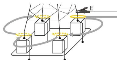
Del mismo modo, conecta las próximas patas del objeto. Teniendo los resultados de la medición de cada pata, puede calcular la resistencia resultante de todo el objeto a partir de la fórmula:
