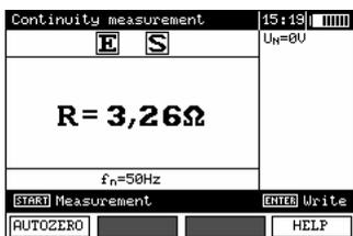
Para eliminar la influencia de la resistencia de los cables de prueba sobre el resultado de la medición, se debe realizar su compensación (puesta a cero automática).
